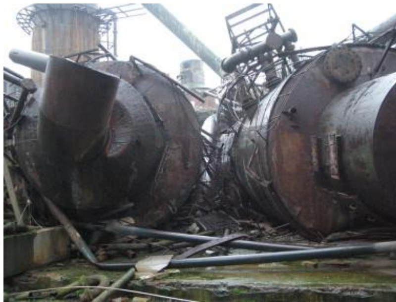
Figura 1.4. Resti di apparecchiature chimiche in seguito al terremoto di Wenchuan del 2008 (Krausmann et al. (2010)).
