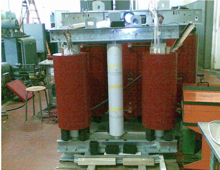
fig. 1.5 Vista posteriore del Trasformatore durante l'assemblaggio
