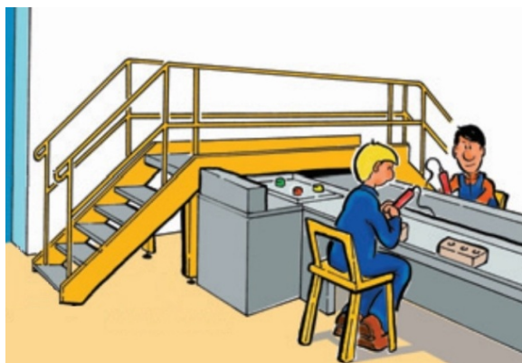
Figura 7.9: passerella con parapetto, sopra una linea di produzione
