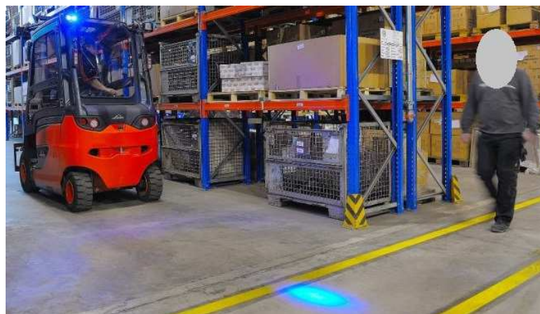
Figura 8.5: avvertimento ottico per segnalare ai pedoni e ad altri conducenti le possibili interazioni con i mezzi in movimento
