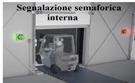
Figura 7.15: automatizzazione del processo con l'utilizzo di cunei bloccaruota automatici e sensoristica semaforica interbloccata
