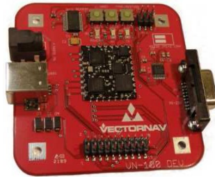
Fig. 16: IMU (Vectornav VN-100).
