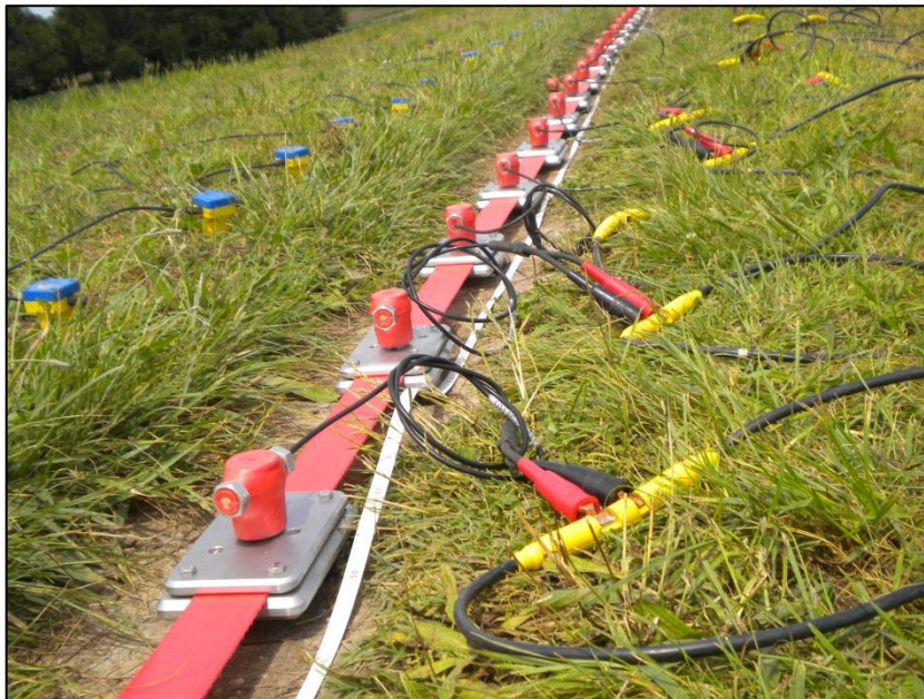
Fig. 28 In primo piano si osserva lo Streamer sismico mentre sulla sinistra si notano i geofoni dello stendimento MASW ordinario.
