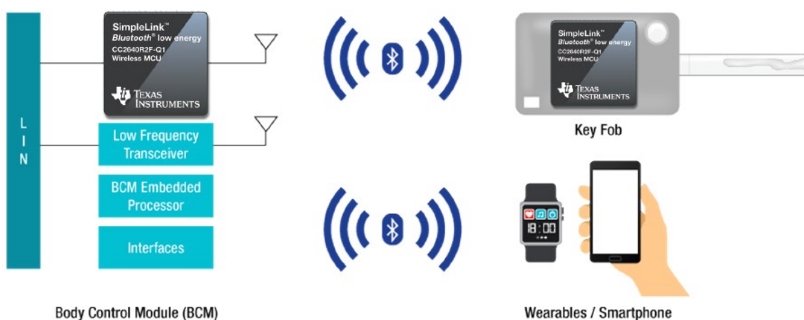
Fig. 10 – Diagramma a blocchi del sistema di accesso al veicolo con Bluetooth Low Energy [28]
