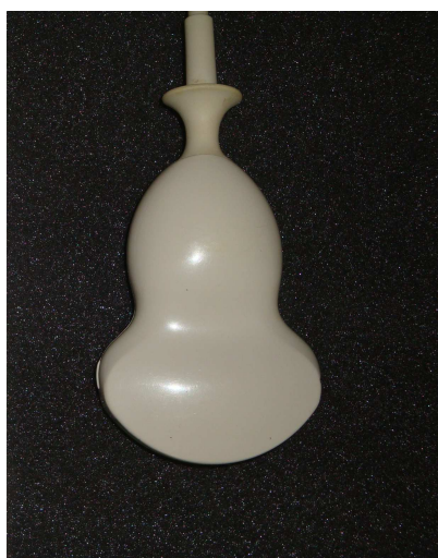
Figura 11. Sonda convex SC3421® multifrequenza da 2,2-4,3-6,6 MHz della Esaote S.p.A.® .
