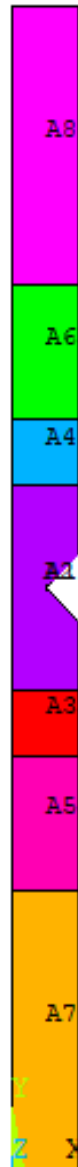
Figura 5.21: suddivisione delle aree per consentire la generazione di una mesh con infittimento graduale.
