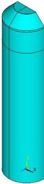
Figura 2.51: volume del provino risultato dell'estrusione attorno all'asse longitudinale di 180°; modellato per le posizioni angolari di cricca simmetriche.
