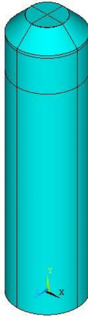
Figura 2.49: volume totale del provino risultato dell'estrusione attorno all'asse longitudinale di 360°; modellato per le posizioni angolari di cricca non simmetriche.
