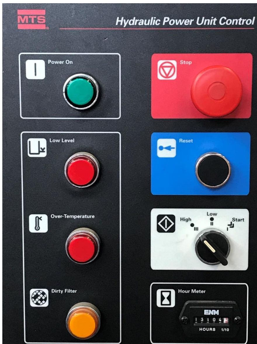
Figura 3.20: particolare dei comandi necessari per l'avvio dell'impianto.
