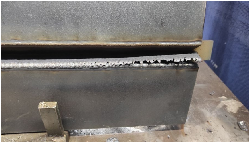
Figura n.2. 6: Formazione della scoria durante il processo di imbullatura. (ARS 15)
