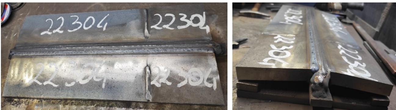
Figura n.2. 5: Risultato finale dopo i 20 step di saldatura (AMC 15) marcato con l'identificativo 22-304
