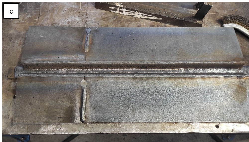
Figura n.2. 3: Step di imburratura: prima parete cianfrinata (a), seconda (b) e tallone (c). Provino AMC 15.
