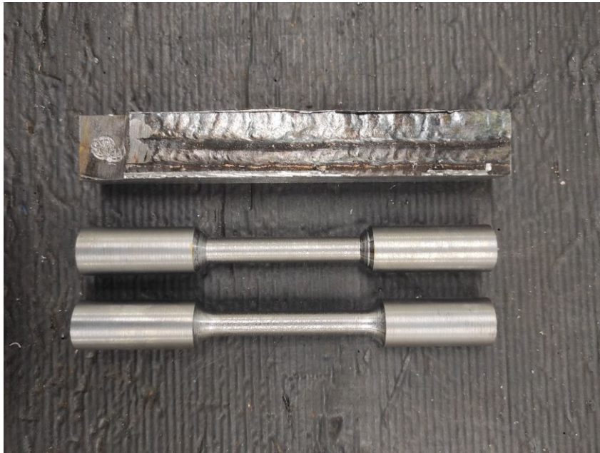
Figura n.2. 10: Materiale asportato dal cordone di saldatura (sopra), step di sgrossatura (metà) e step di finitura (sotto).
