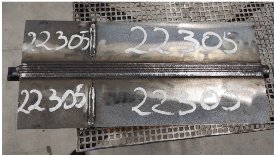
Figura n.2. 7: Risultato alla fine del processo di saldatura (ARS 15). Il saggio di ARS 15 è marcato con l'identificativo 22-305
