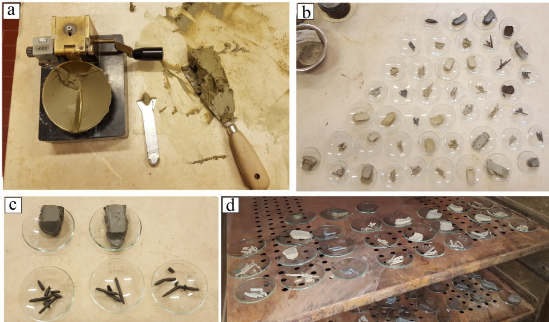
Figura 2.7 - Determinazione dei limiti: a) cucchiaio di Casagrande utilizzato per la determinazione del limite liquido; b), c) e d) terreni dai quali (attraverso la perdita di acqua) sono stati individuati il WL e WP.
