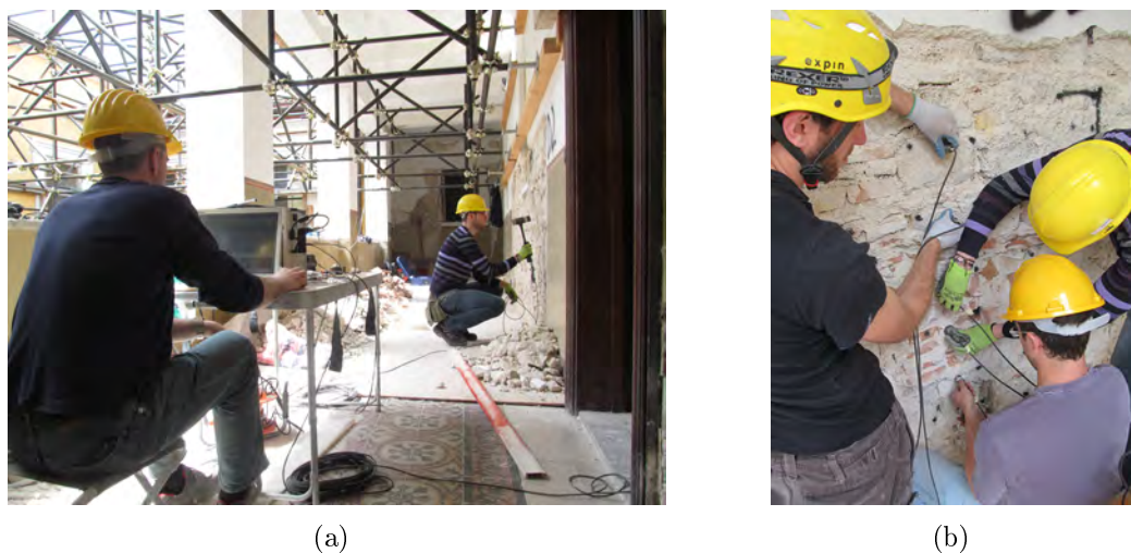
Figura 3.32: Esecuzione di trasparenza sonora (a), esecuzione di tomografia sonora (b)
