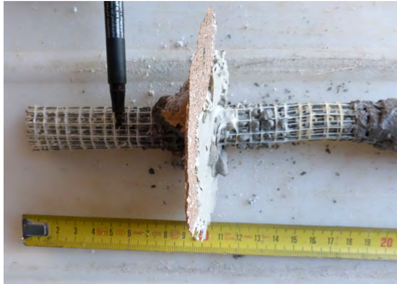
Figura 5.3: Esempio di rottura conica con grande superficie di laterizio esfoliato.
