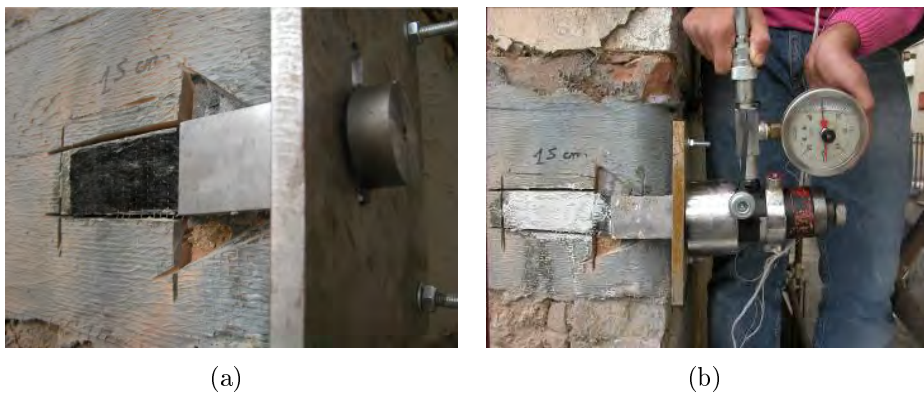
Figura 2.35: Direct Shear Test: (a) dispositivo di ancoraggio; (b) esecuzione prova (Borri e altri, 2009a)
