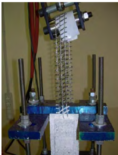
Figura 2.47: Shear Test: rottura provino (Carozzi e altri, 2012)
