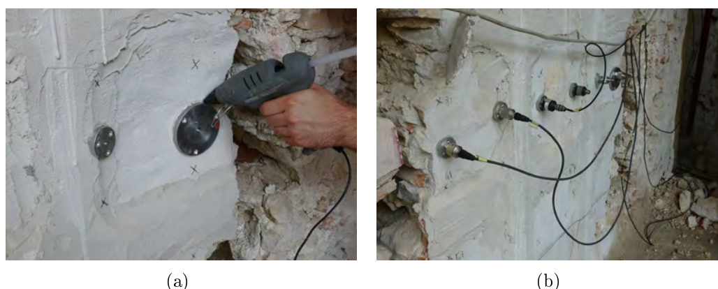
Figura 3.39: Accelerometri per prove tomografie soniche
