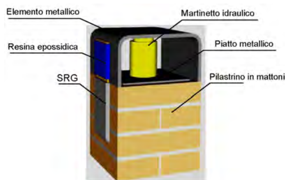
Figura 2.44: Schema di prova (Borri e altri , 2009b)
