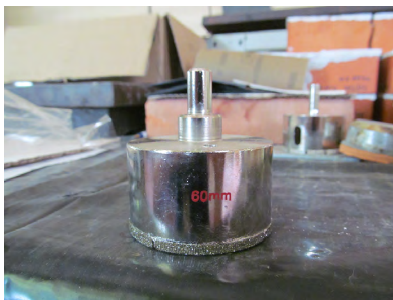
Figura 1.21: Tazza diamantata da 60 mm di diametro, prova pull-off
