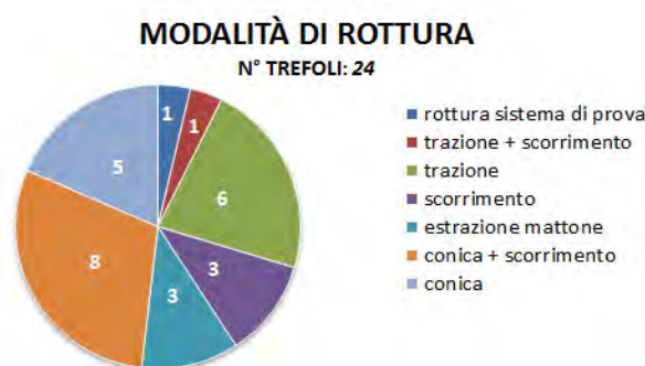
Figura 4.43: Modalità di rottura per i connettori da 24 trefoli
