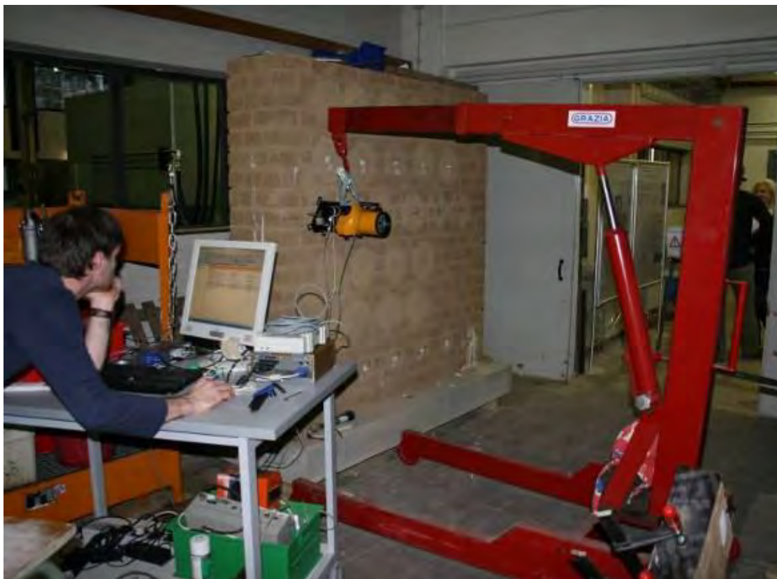
Figura 2.61: Esecuzione del test su parete in muratura (NIKER, 2013b)
