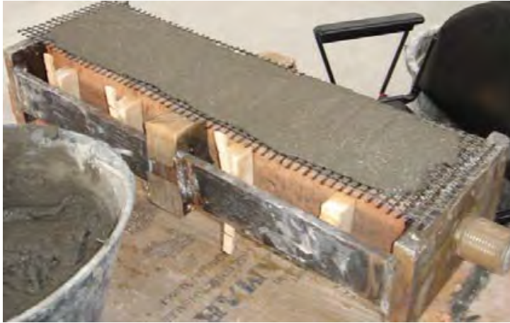
Figura 2.30: Prove di trazione CFRCM su muratura (Faella e altri, 2009)
