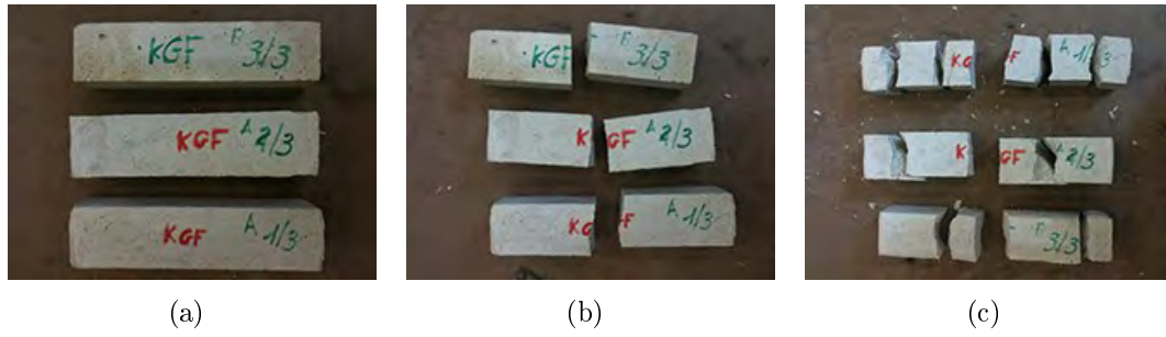
Figura 3.4: Tre provini, prima dei test (a), dopo la rottura a flessione (b) e dopo la rottura a compressione (c)
