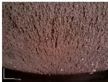
(d) Crack initiation point with 188.3x magnification
