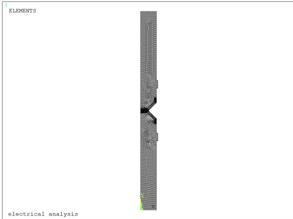
Figura 3.7: Meshatura della geometria con dimensione di elemento media pari a 0.00075 m
