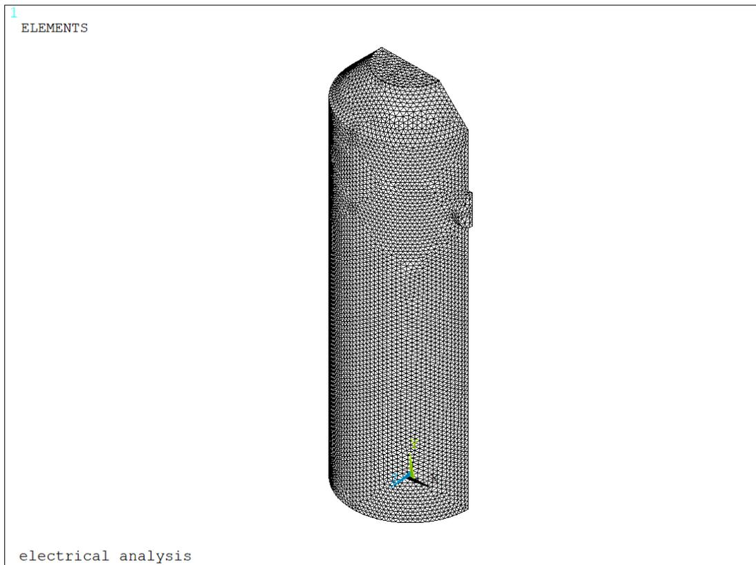
Figura 3.35: Meshatura della geometria 3D con dimensione di elemento media pari a 0.00075 mm
