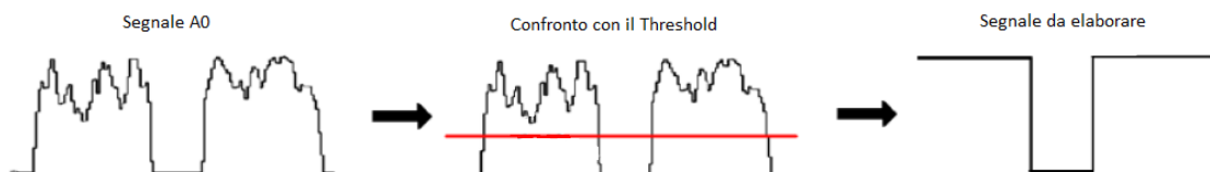
Fig.6.2.5 – Elaborazione segnale con il metodo di Threshold
