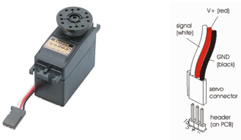
Fig 5.1.2 – Connettori del servo Futaba
