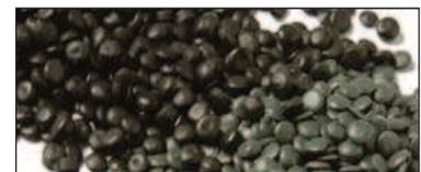
**Figura 3.1: esempio di granulo rigenerato**
