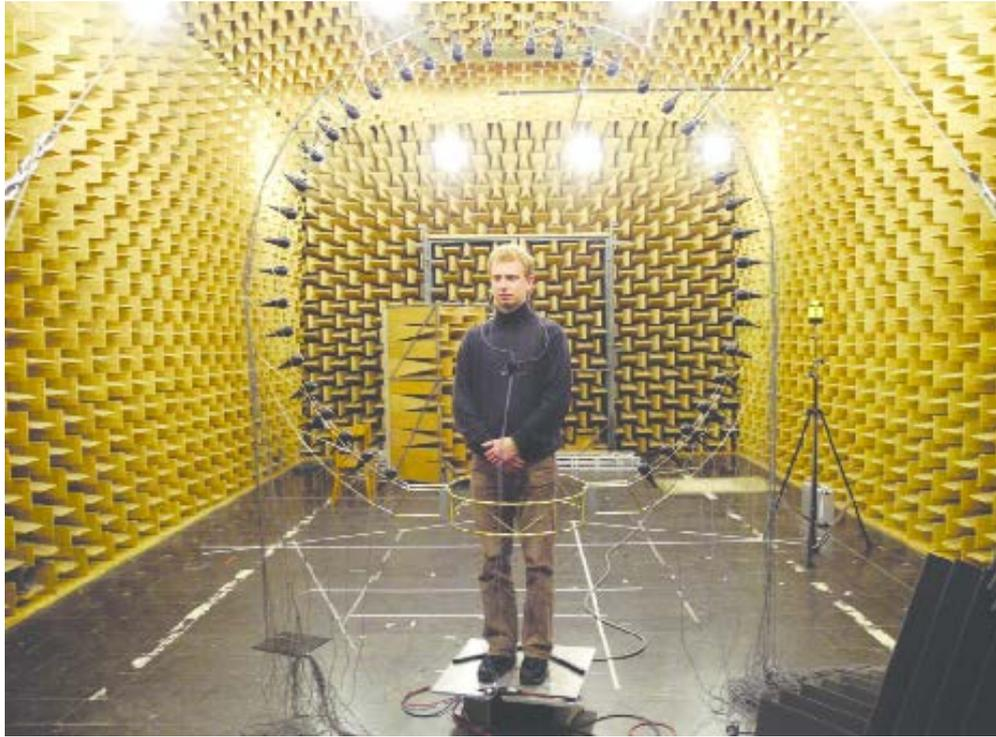
Figura 2.8: Set-up in uso per la misurazione dell'HRTF [3]
