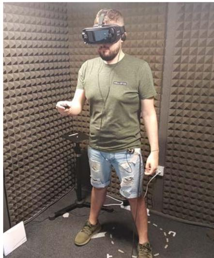
**Figura 4.18:** Condizioni dell'esperimento: il soggetto si posiziona al centro della camera insonorizzata con la luce spenta per tutta la durata del test.
