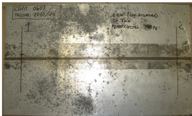
Figura 4.9.: saldatura EBW su acciaio zincato
