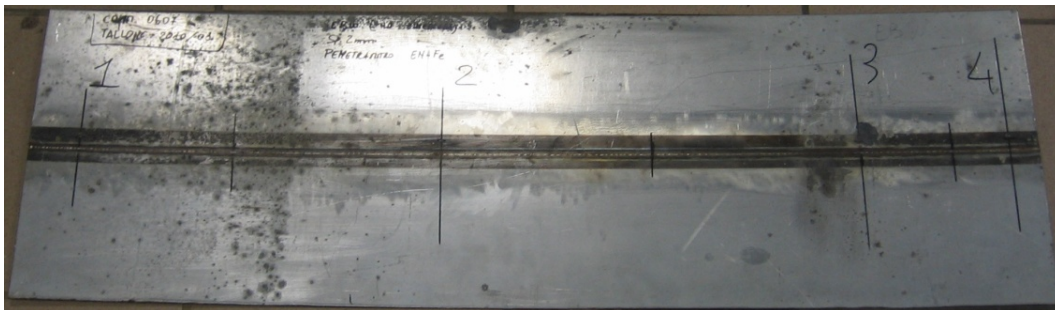
Figura 4.8.: saldatura EBW su acciaio non zincato
