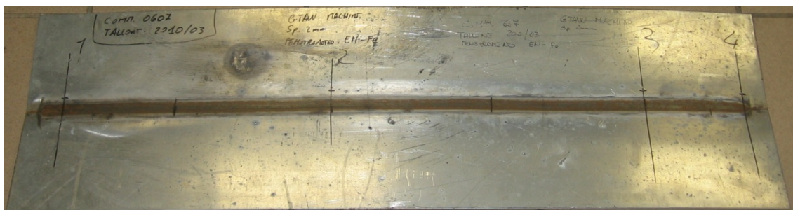
Figura 4.4.: saldatura GTAW su acciaio non zincato
