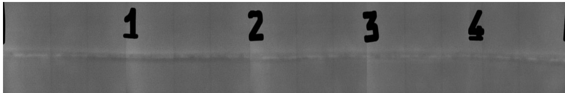
Figura 4.12.: immagini ai raggi X cordone saldatura PAW su acciaio non zincato
