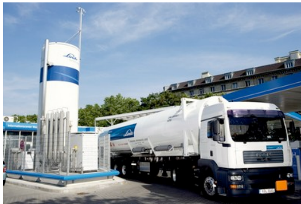
Fig. 14: autocarro criogenico per il trasporto di idrogeno liquido
