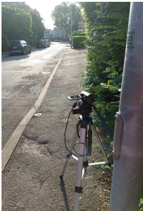
Figura 32: Esempio di posizionamento di una videocamera per rilevamento targhe su treppiede
