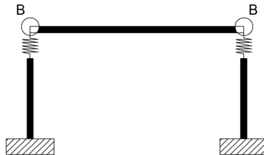
Figura 559 - Zone in cui sono presenti i giunti
