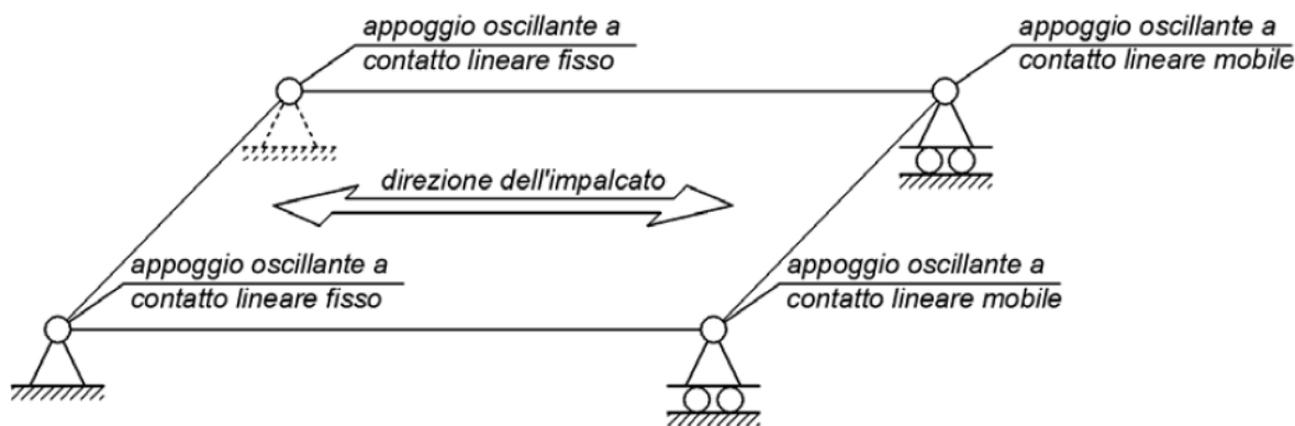
Figura 404 - Schema statico del ponte e dei suoi appoggi
