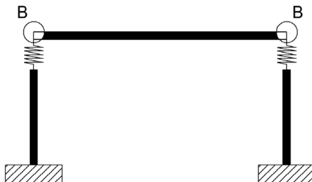
Figura 362 - Zone in cui sono presenti i giunti
