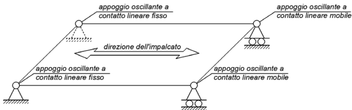
Figura 533 - Schema statico del ponte e dei suoi appoggi
