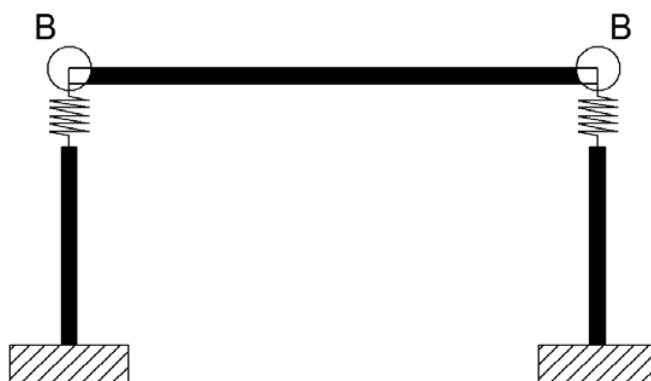
Figura 423 - Zone in cui sono presenti i giunti
