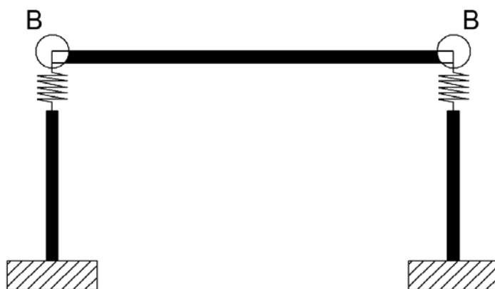
Figura 477 - Zone in cui sono presenti i giunti
