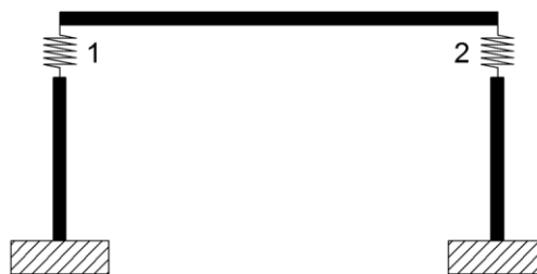
Figura 351 - Rappresentazione degli appoggi nel modello
