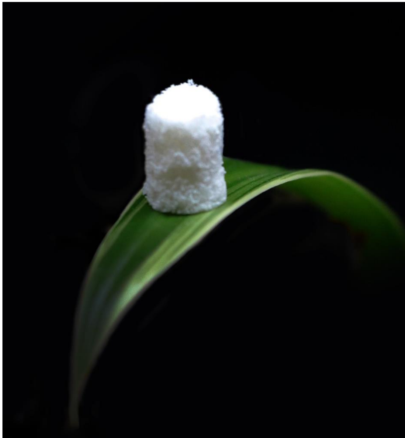
Figura 7.31: Campione 100%SF ottenuto mediante tecnica Solvent Casting
