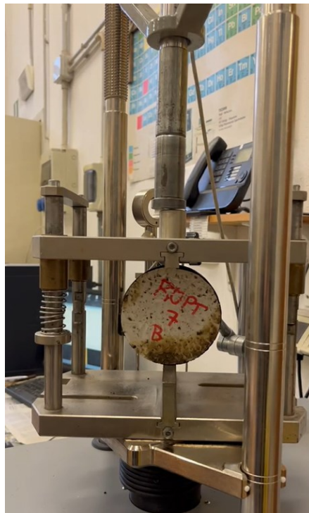
Figura 4.25: Esecuzione prova ITS.
