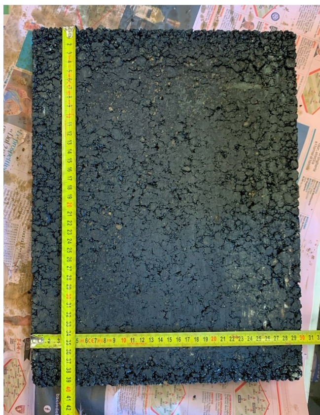
Figura 4.23: Lastra conglomerato bituminoso dopo Roller Compactor.
