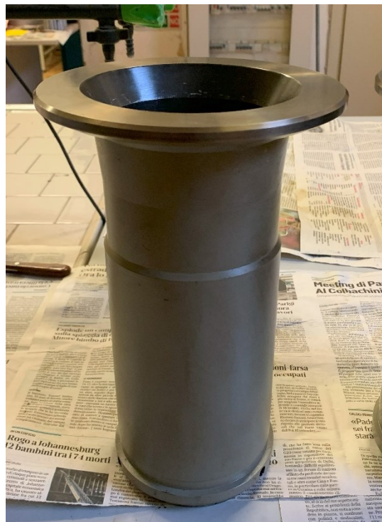
Figura 4.20: Fustella per realizzazione provini mediante SGC.
