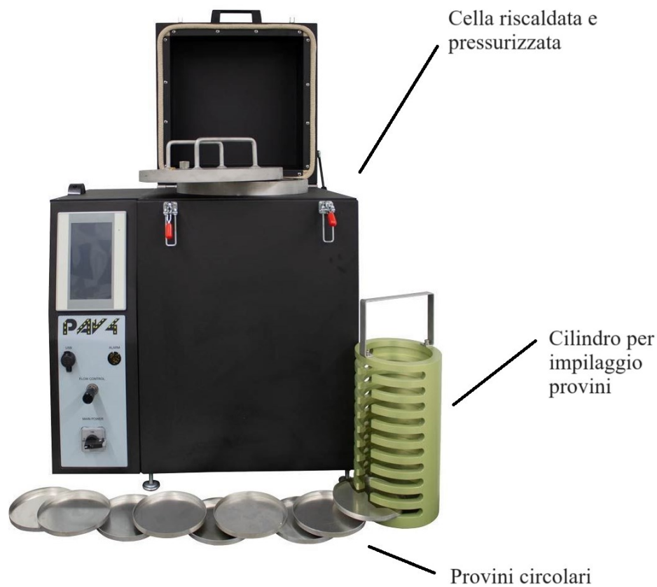
Figura 4.14: Rappresentazione strumentazione prova PAV.
