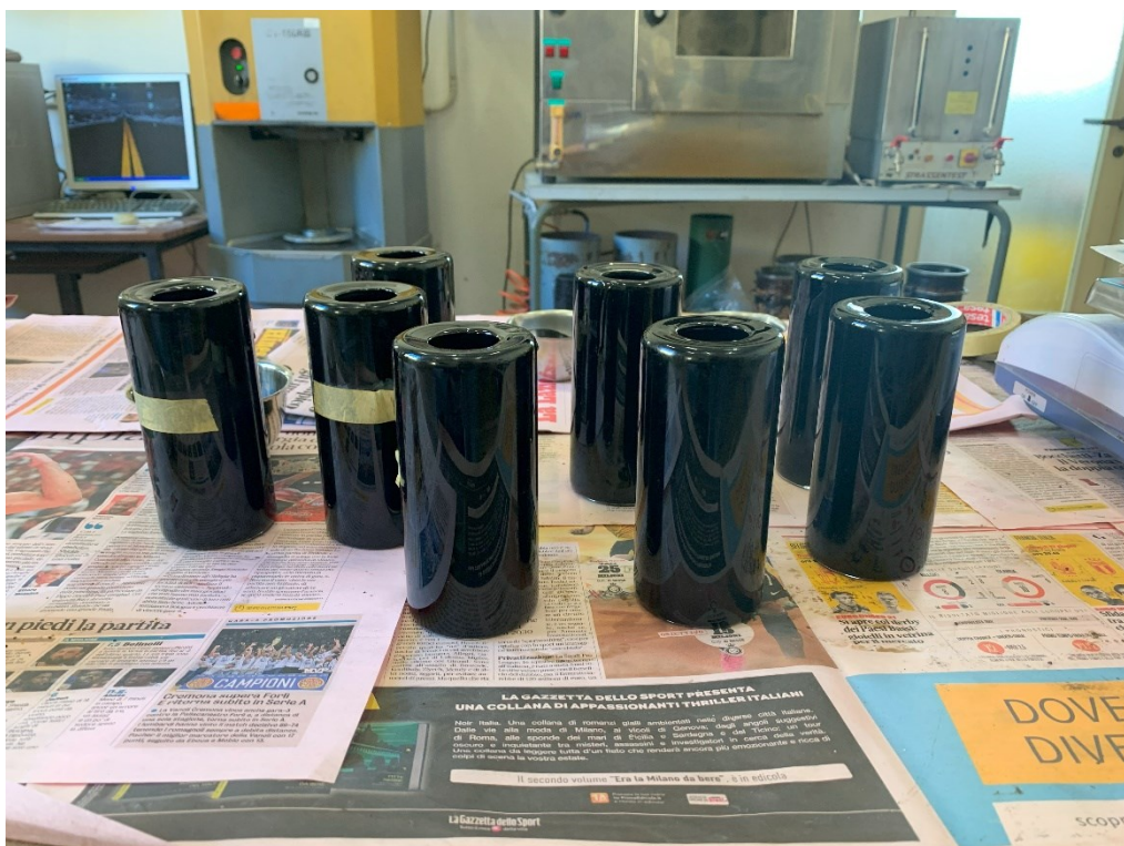
Figura 4.12: Recipienti in vetro dopo la prova RTFOT.
