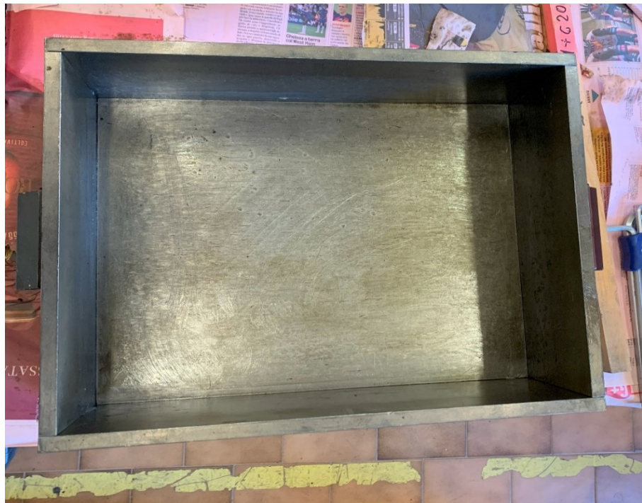
Figura 4.22: Cassero per Roller Compactor.
