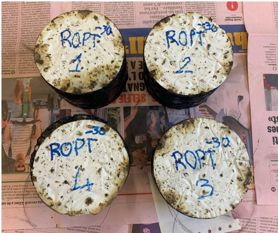
Figura 4.19: Provini realizzati mediante compattazione con SGC.
