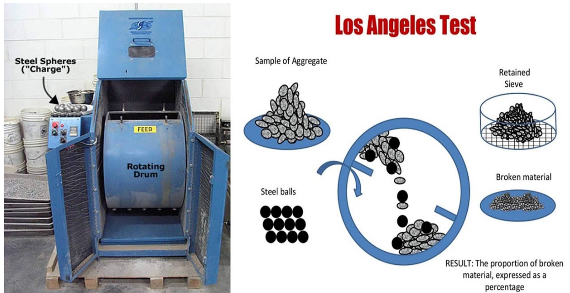
Figura 4.5: Prova Los Angeles.
