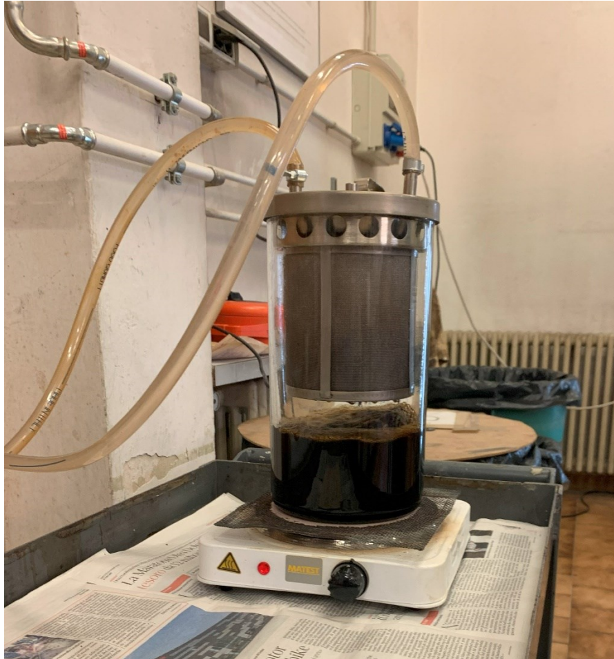
Figura 4.1: Estrattore a caduta.
