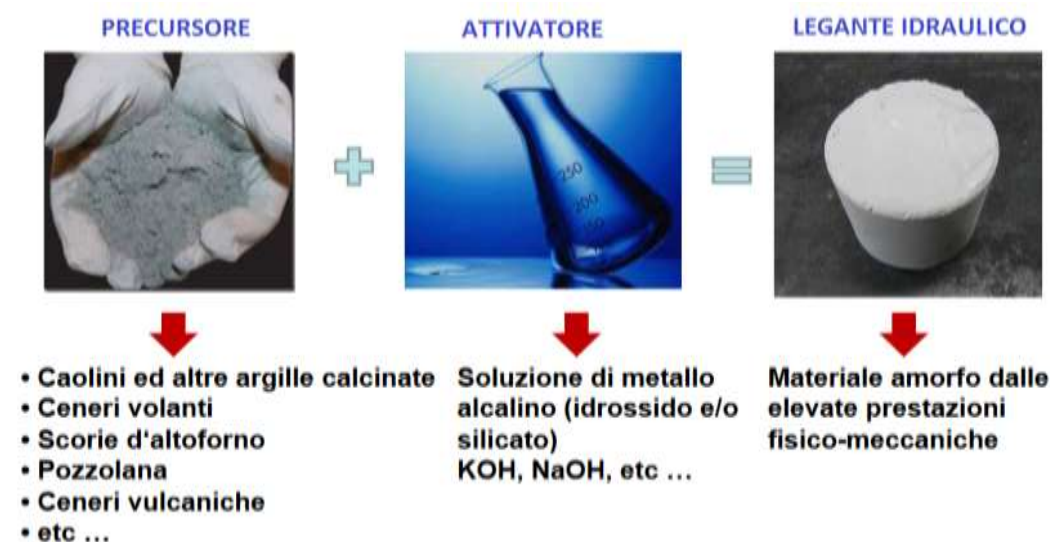
Fig. 2.1: Materie prime necessarie per la produzione di leganti idraulici ad attivazione alcalina, alternativi al cemento Portland.
