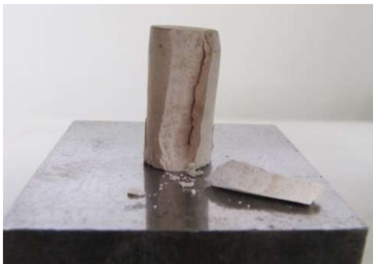
Fig. 5.1: Rottura di un provino di metacaolino.
