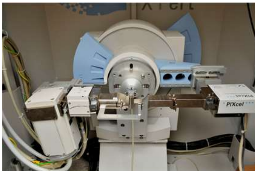
Fig. 3.2: Diffratometro PANalytical X'Pert PRO in geometria Bragg-Brentano in modalità \theta - \theta in riflessione, in dotazione al Dipartimento di Geoscienze dell'Università di Padova
