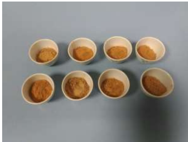
Fig. 4.8: Crogioli refrattari utilizzati per il trattamento termico delle argille
