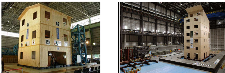
Fig.1.6 Progetto SOFIE: Prova sismica su edificio a 3 piani [7] e 7 piani [44]
