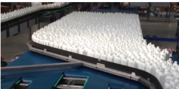
Immagine 3 : Buffer di una linea di imbottigliamento
