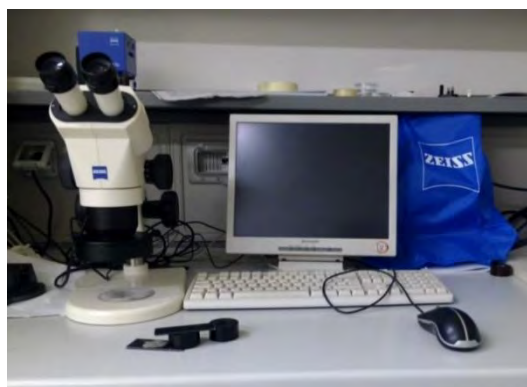
Figura 3.6 Stereomicroscopio Zeiss per l'indagine della superficie delle viti in acciaio inossidabile.
