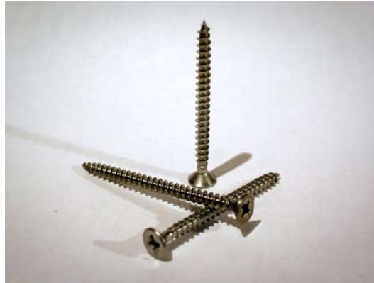
Figura 3.2 Esempio di viti autofilettanti in acciaio inossidabile A2 a testa svasata piana con impronta a croce Pozidriv 4,8X60 mm.
