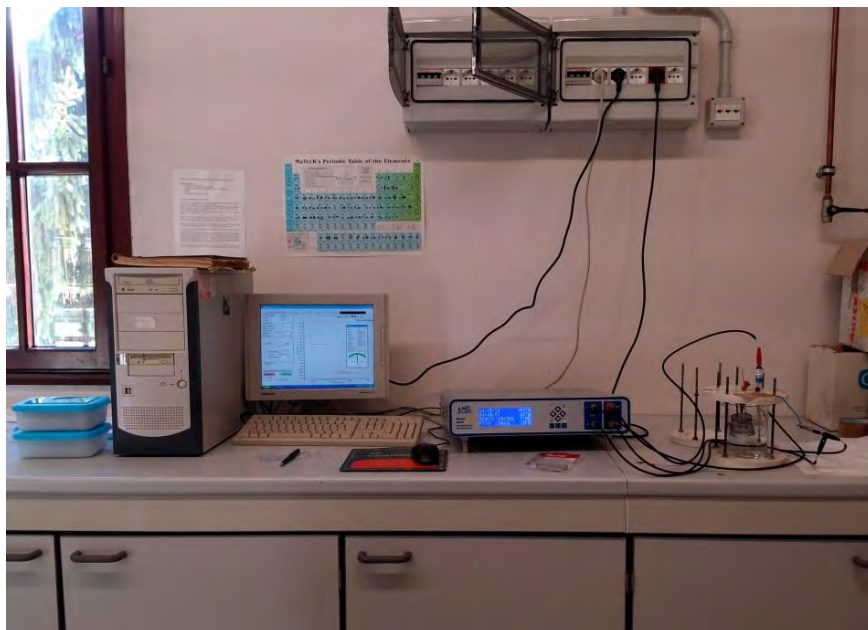
Figura 3.4 Configurazione per la prova di polarizzazione anodica. Da sinistra a destra si possono vedere il PC per l'elaborazione dei dati, il potenziostato e la cella elettrochimica.
