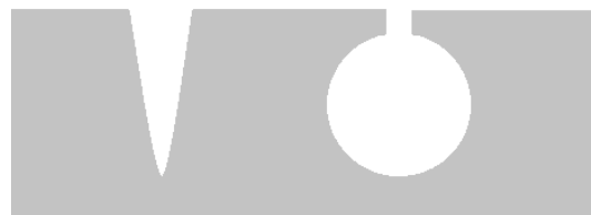
Figura 2.13 Rappresentazione schematica di un metallo affetto da pitting penetrante (a sinistra) e da pitting cavernizzante (a destra). In entrambi i casi si nota come sia difficile valutare l'entità del fenomeno dalla semplice analisi della superficie.
