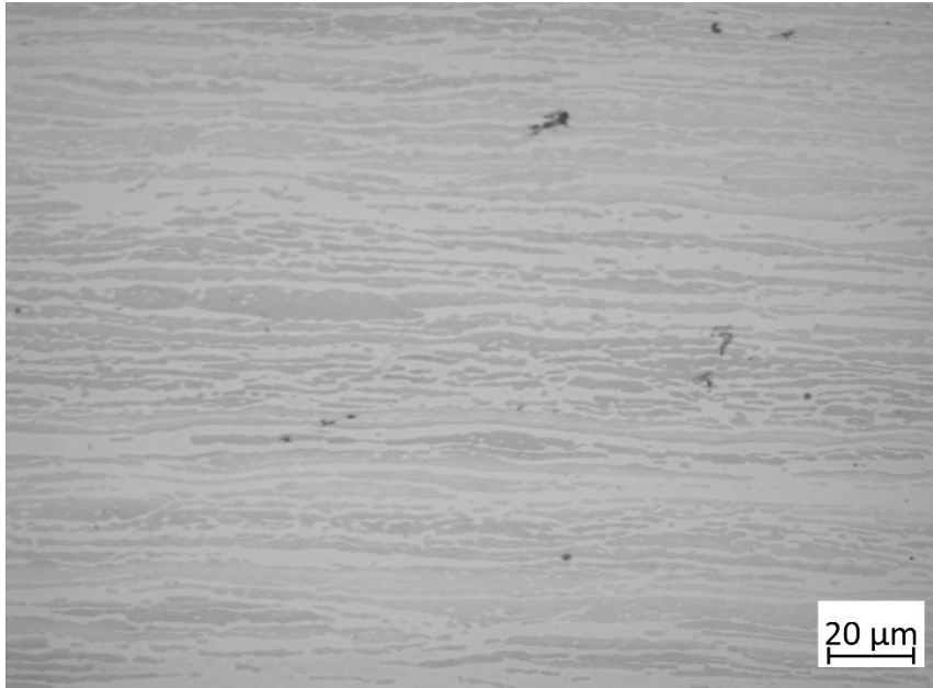
Figura 1:Foto microstruttura acciaio duplex SAF 2507, al microscopio ottico in 5x
