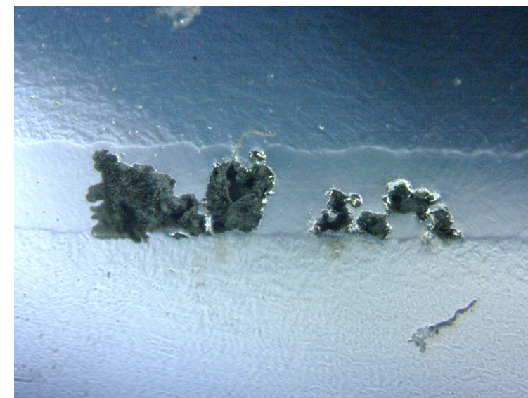
Figura 12: immagine pit quarto campione a seguito della polarizzazione anodica a 70 ° C
