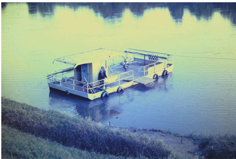
Figura 35. Il traghetto di Pettorazza Papafava in una diapositiva del 1984: il ferro ha sostituito il legno, ma la struttura è rimasta la stessa, con la fune maestra di ancoraggio visibile a destra. Foto di Polo L.
