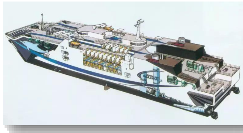
Figura 3: La Super Liner Ogasawara, costruita nel 2005, è la più grande imbarcazione realizzata con saldatura ad attrito (FSW).
