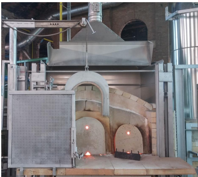
Figura 83 - Forno a crogiolo di nuova costruzione, da notare la cappa isolante sovrastante il forno e il sistema servoassistito di movimentazione delle portine e dei riduttori di apertura bocche
