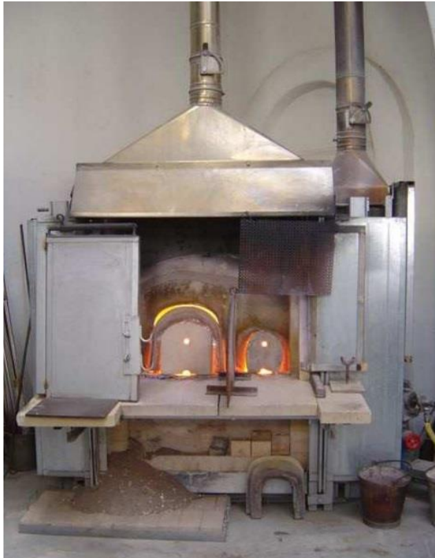
Figura 61 - Forno a crogiolo (fonte MT s.r.l.)
