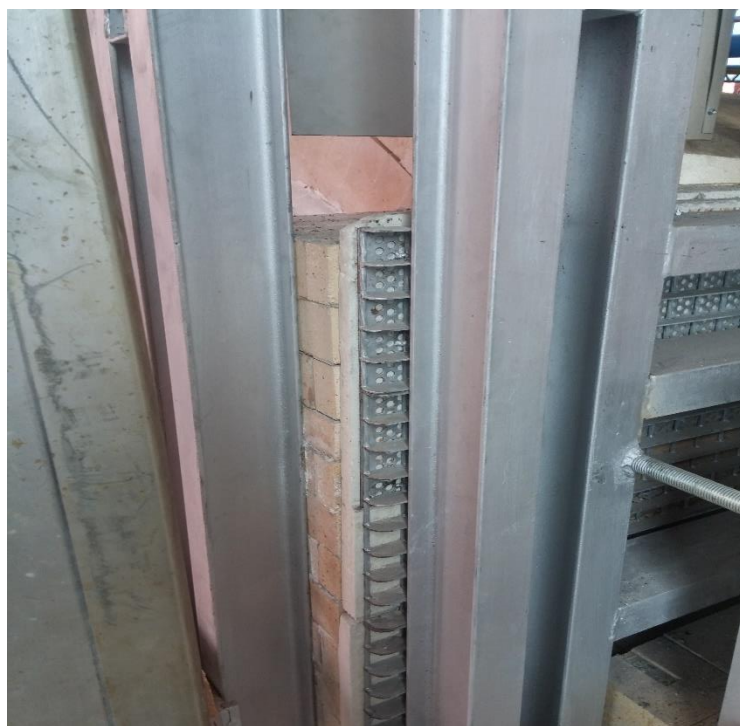
Figura 69 - Forno a crogiolo di nuova costruzione: dettaglio di grigliato esterno disperdente
