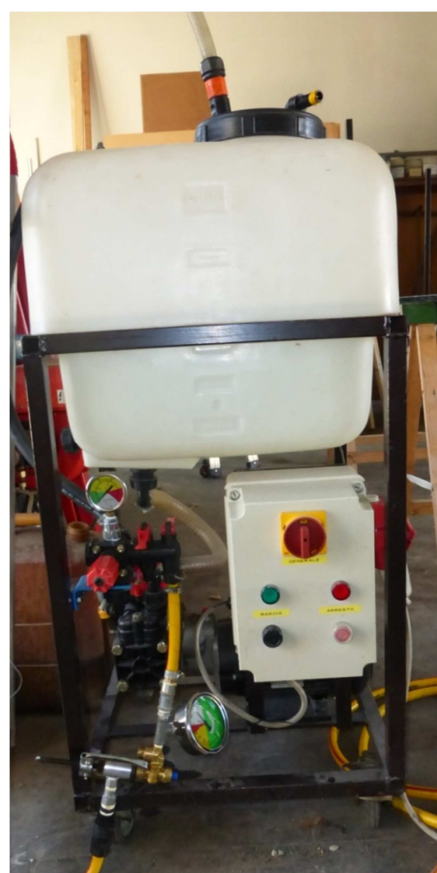
Figura 31: Pompa utilizzata per portare in pressione l'acqua
