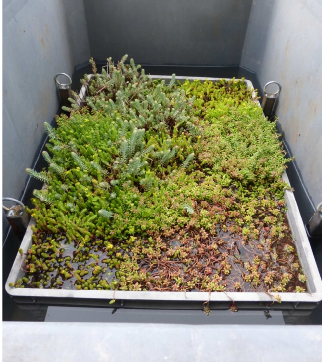
Figura 38: Immersione della cassetta in acqua per 12h
