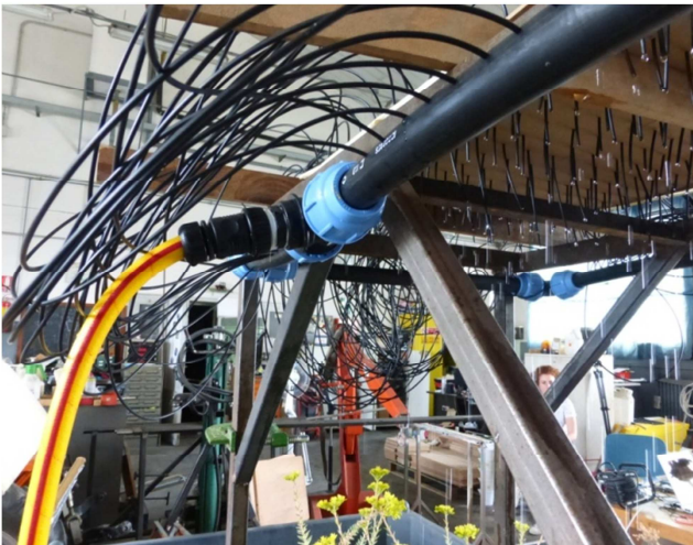
Figura 34: Dettaglio del tubo collettore e dell'innesto con la presa d'acqua proveniente dalla pompa
