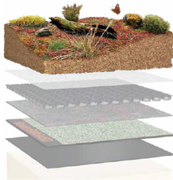
Figura 11: Esempio di stratigrafia di biotopo pensile ideato da Bauder (Bauder S.r.l. 2015)
