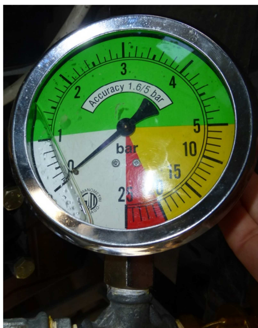
Figura 36: Manometro raccordato alla pompa per regolare con precisione la pressione in uscita
