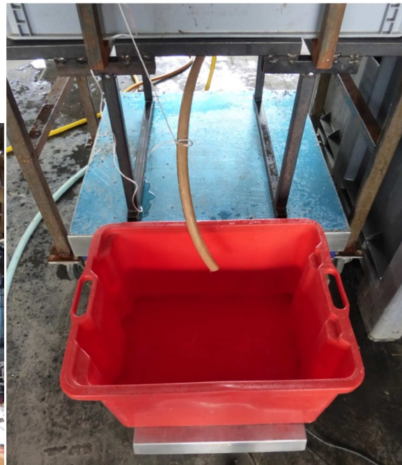
Figura 35: Dettaglio dello scarico che convoglia l'acqua drenata nel contenitore per la pesata
