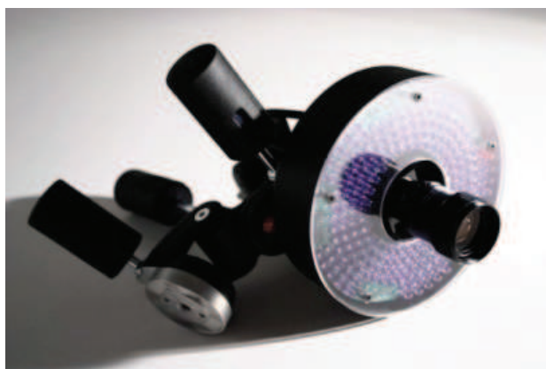
3.1.2 - Telecamera con illuminatori ad infrarosso presente nel sistema stereofotogrammetrico [34]
