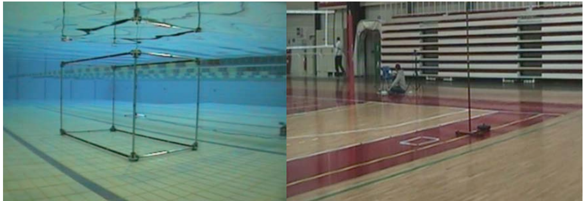
3.1.8 - Esempio di griglia e scacchiera utilizzate per la calibrazione estrinseca delle telecamere
