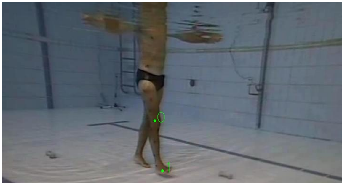
3.5.2 - Esempio di inseguimento a video dei punti di reperi in acquisizioni subacquee
