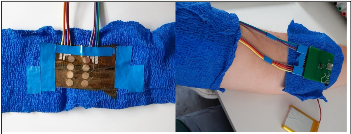
Figura 30. (A sinistra: matrice collegata e attaccata alla fascia in Coban, a destra: l'elettronica appoggiata all'avambraccio mediante una seconda fascia durante una contrazione del bicipite)
