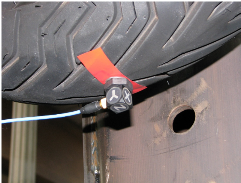
Figura 2.9: particolare del posizionamento dell'accelerometro
