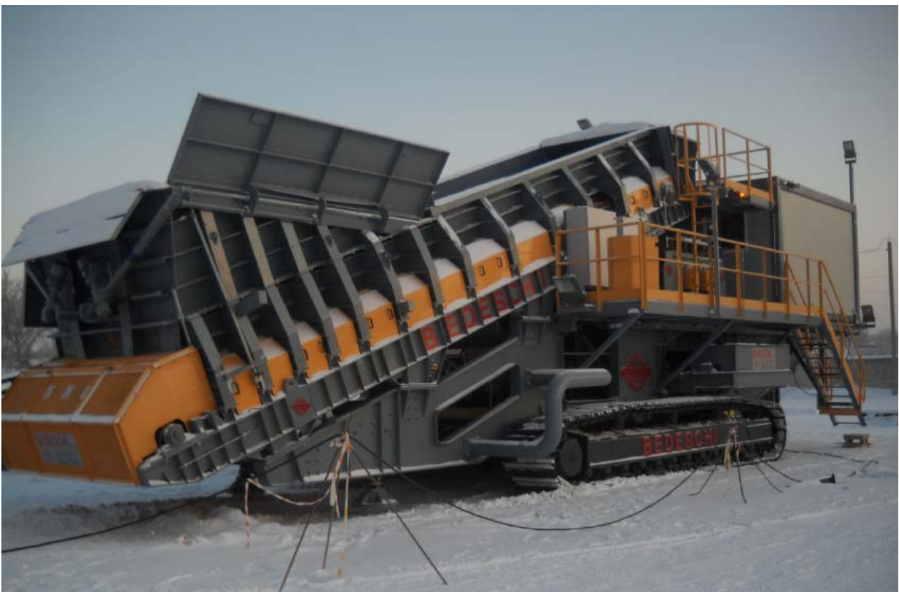
Figura 1.7 Crushing group RL650/2200 sul cantiere di Shurovski Cement – Russia.
