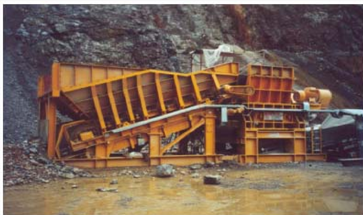
Figura 1.3 Frantumatore pesante: resistenza del materiale alla compressione fino a 1800 \text{ kg/cm}^2 , diametri fino a 1200 \text{ mm} , larghezza fino a 2000 \text{ mm} , output fino a 1000 \text{ t/h} .
