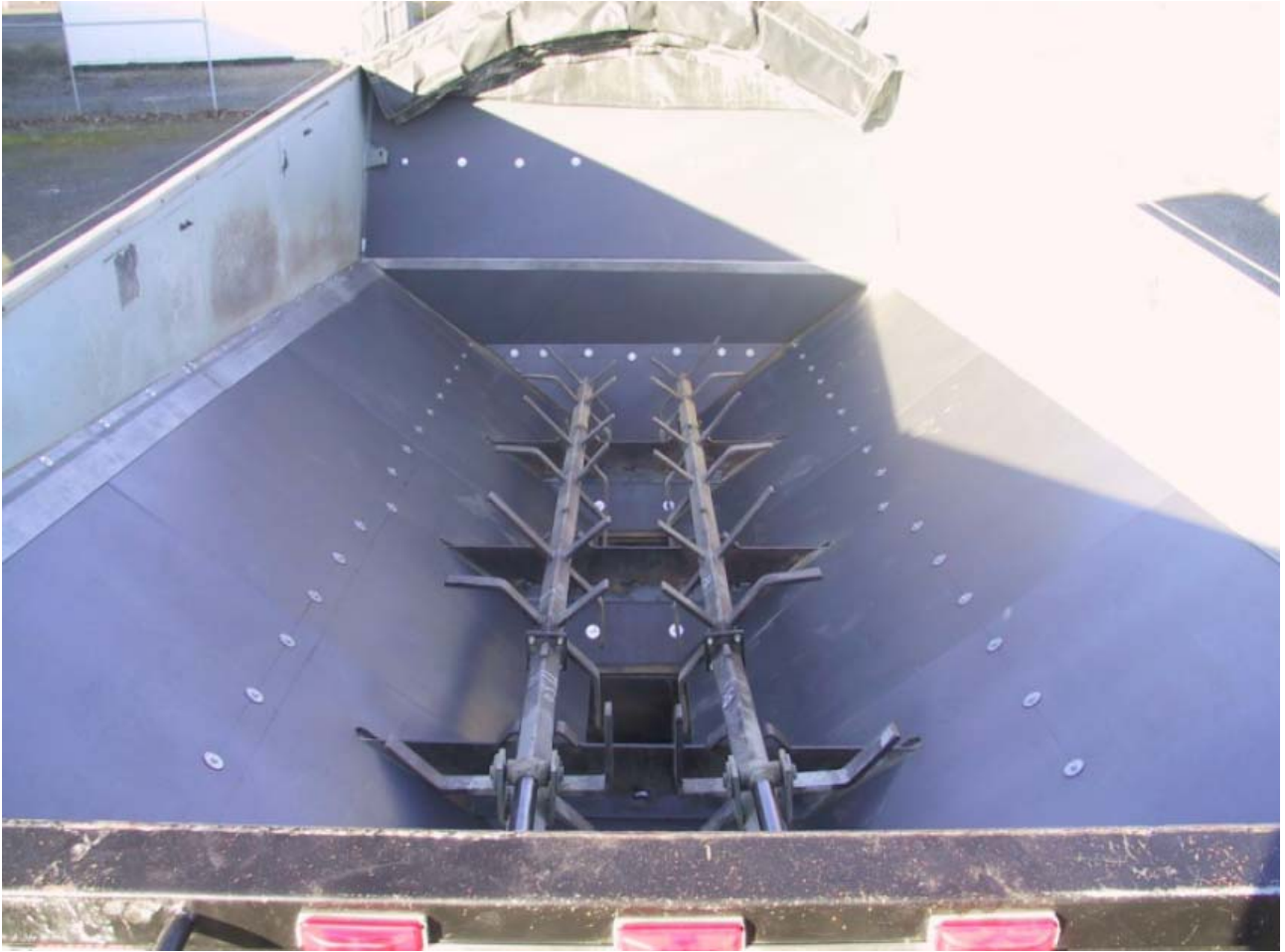
Figura 4.5 Immagine delle tramoggia con il rivestimento applicato.
