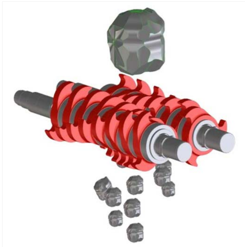
Figura 1.5 Rulli dentati del frantumatore - principio di funzionamento.
