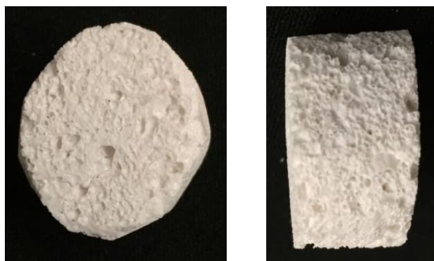
Figura 5.5 Schiume polimeriche rigide ( superfici lavorate ) ottenute con 9 ml di isopropanolo e meno di 2 h di agitazione meccanica tramite mixer (1000 rpm).
