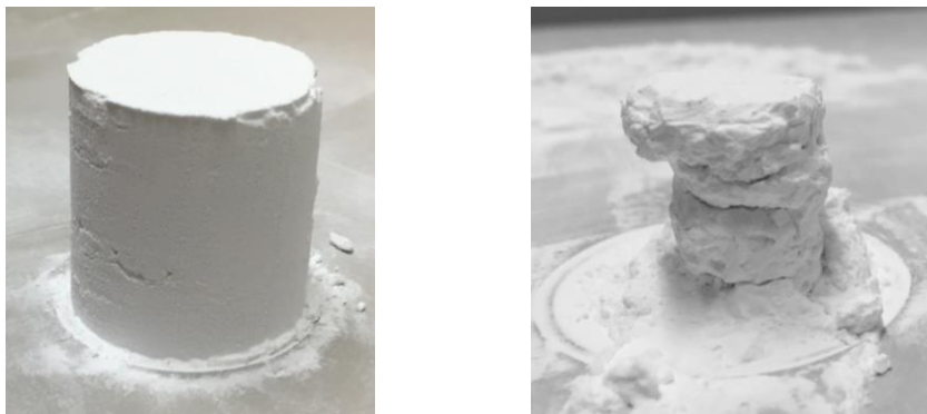
Figura 4.26 (sinistra) cilindro estratto dalla siringa costituito da polvere bagnata e polvere asciutta. (destra) parallelepipedo realizzato con stampa indiretta, emerso dopo la rimozione della polvere asciutta.
