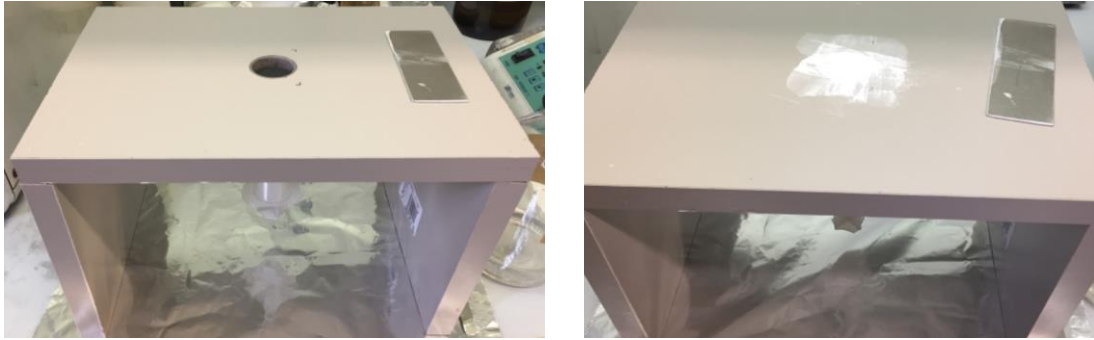
Figura 4.25 (sinistra) Siringa e supporto utilizzati per il secondo tentativo di stampa indiretta. (destra) apparato strumentale dopo la distribuzione delle polveri.
