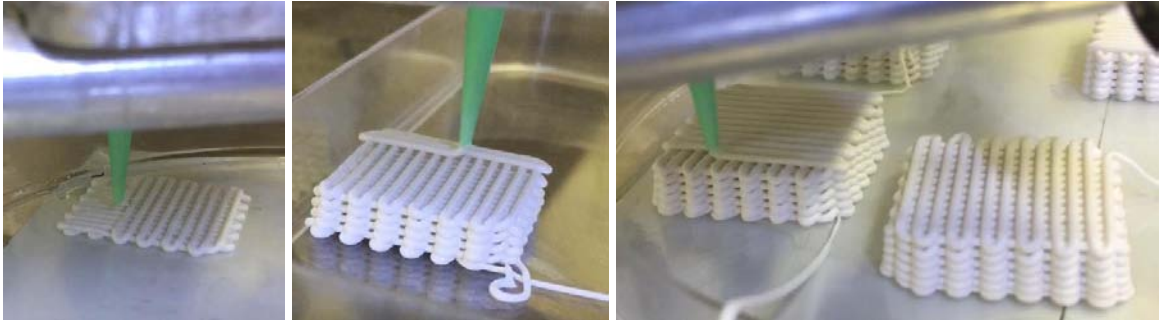
Figura 4.7 Sequenza di realizzazione della stampa di scaffolds ( \phi = 800 \mu\text{m} ; porosità 0,8 mm).
