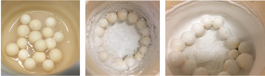
Figura 4.5 Fasi del processo di realizzazione dell'inchiostro: (sinistra) miscela MK–isopropanolo–Silica fume; (centro) aggiunta dei fillers; (destra) inchiostro pronto.
