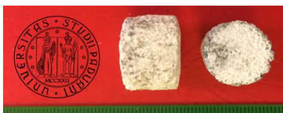
Figura 5.9 Geometria ottenuta per gli scaffold dopo l'opportuna lavorazione per eliminare i bordi.
