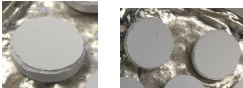
Figura 3.6 Pastiglie che non riescono a mantenere la forma e la consistenza.
