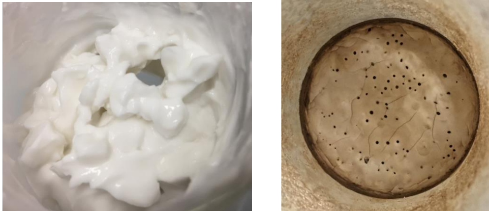
Figura 3.13 (a sinistra) miscela realizzata con la Silice colloidale prima dell'essiccazione. (a destra) miscela con Silice quarzo dopo essiccazione.
