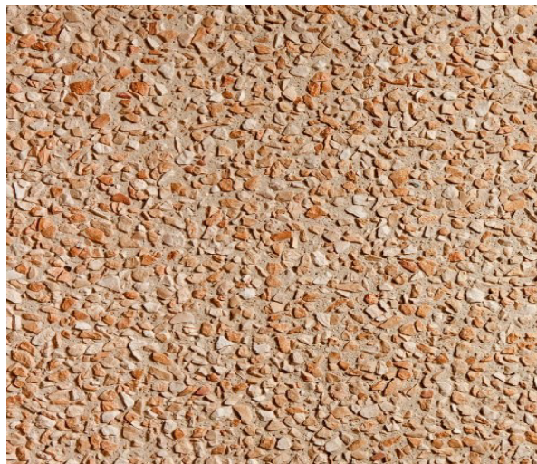
Fig.5.5: il calcestruzzo architettonico
