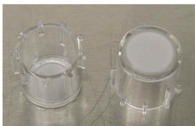
Figura 3 A sinistra si vede il supporto in policarbonato nella posizione di arrivo, a destra si vede il supporto rovesciato per rendere visibile la zona dove si localizza l'epitelio oculare
