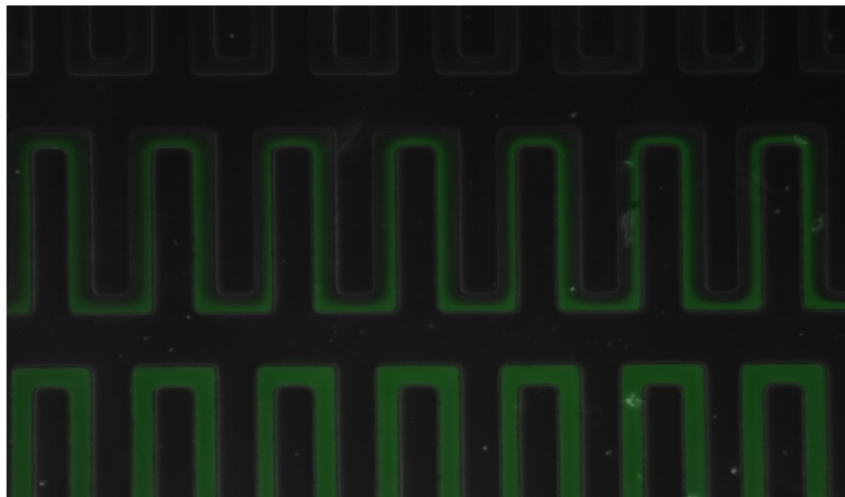
Figura 3.14. Particolare della diramazione dei canali all'ingresso.
