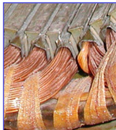
Fig. 4-3 Particolare della costruzione di un avvolgimento di bassa tensione
