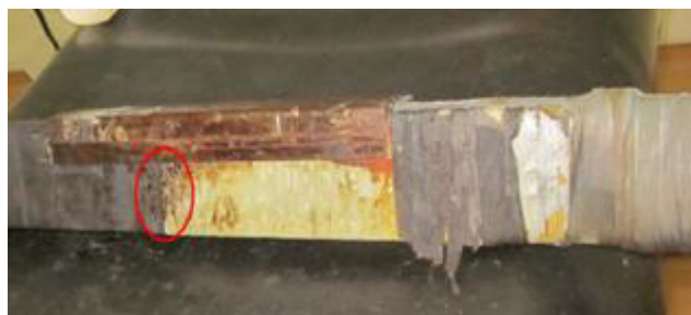
Fig. 4-8 Danno su una matassa di un avvolgimento statorico dovuta a sfregamento (fonte: sciencepublishinggroup.com)
