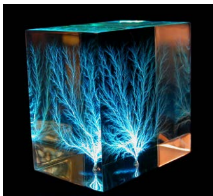
Fig. 2-8 Figure di Lichtenberg all'interno di un blocco trasparente di materiale acrilico (fonte: Wikipedia.org)
