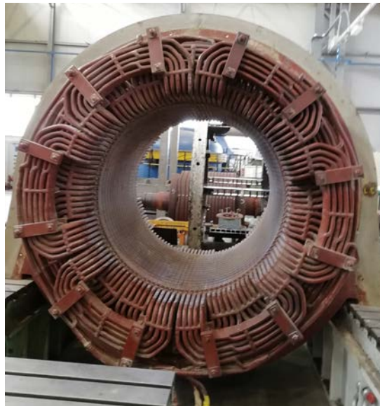
Fig. 8-17 Vista frontale dello statore della macchina BBC
