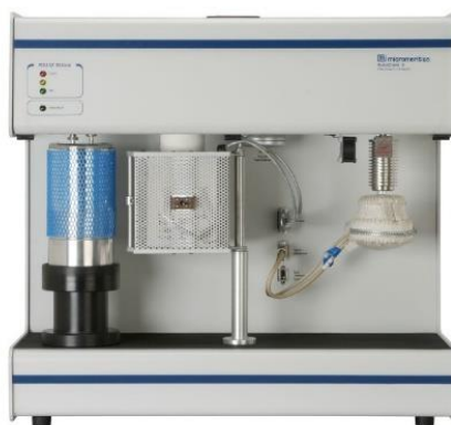
Figura 2.19: Autochem II, Chemisorption Analyzer utilizzato per la misura BET.
