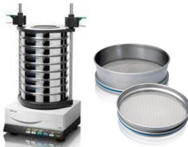
Figura 3.2: Vibrovaglio e setacci utilizzati per dividere le polveri.
