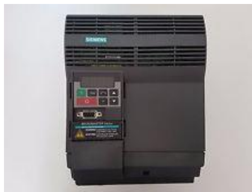
Figura 2.12: Rappresentazione inverter Siemens Micromaster utilizzato.
