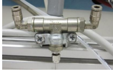
Figura 2.25: Raccordo a T per analisi in parallelo della miscela.
