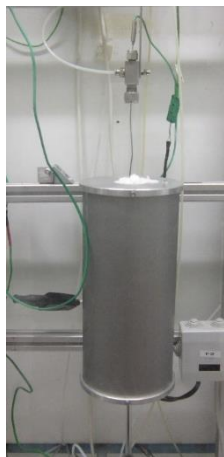
Figura 2.24: Tubo di quarzo inserito nel forno riscaldante.
