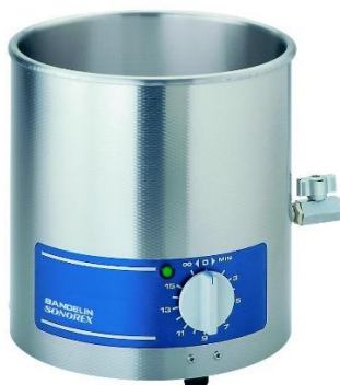
Figura 3.1: Rappresentazione di vasca a ultrasuoni utilizzata per il lavaggio dei filtri.
