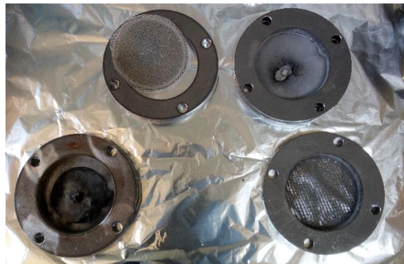
Figura 2.5: Filtri metallici utilizzati come sistema di raccolta polveri.
