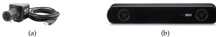
Figura 9: Telecamere digitali utilizzate durante le prove sperimentali: (a) telecamera HD ELP (b) telecamera stereo ZED 2i [9, 20]
