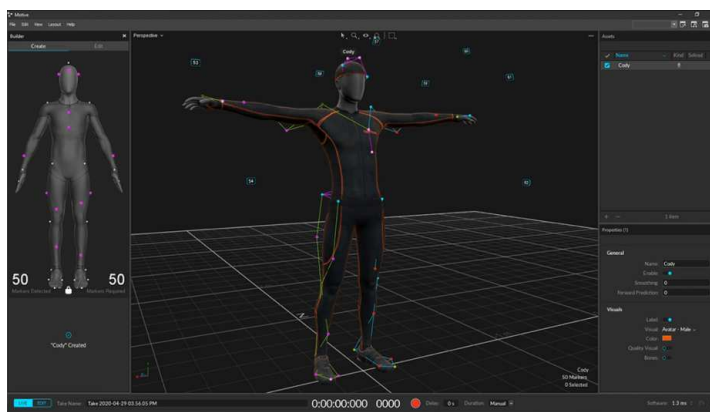
Figura 7: Esempio di utilizzo del software Motive, utilizzato per ricostruire i movimenti di un corpo umano partendo dalla rilevazione da parte di un sistema di visione OptiTrack di un set composto da 50 marker riflettenti [40]
