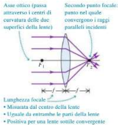
Fig. 1.1(a) Lente convergente con raggi entranti paralleli all'asse ottico
