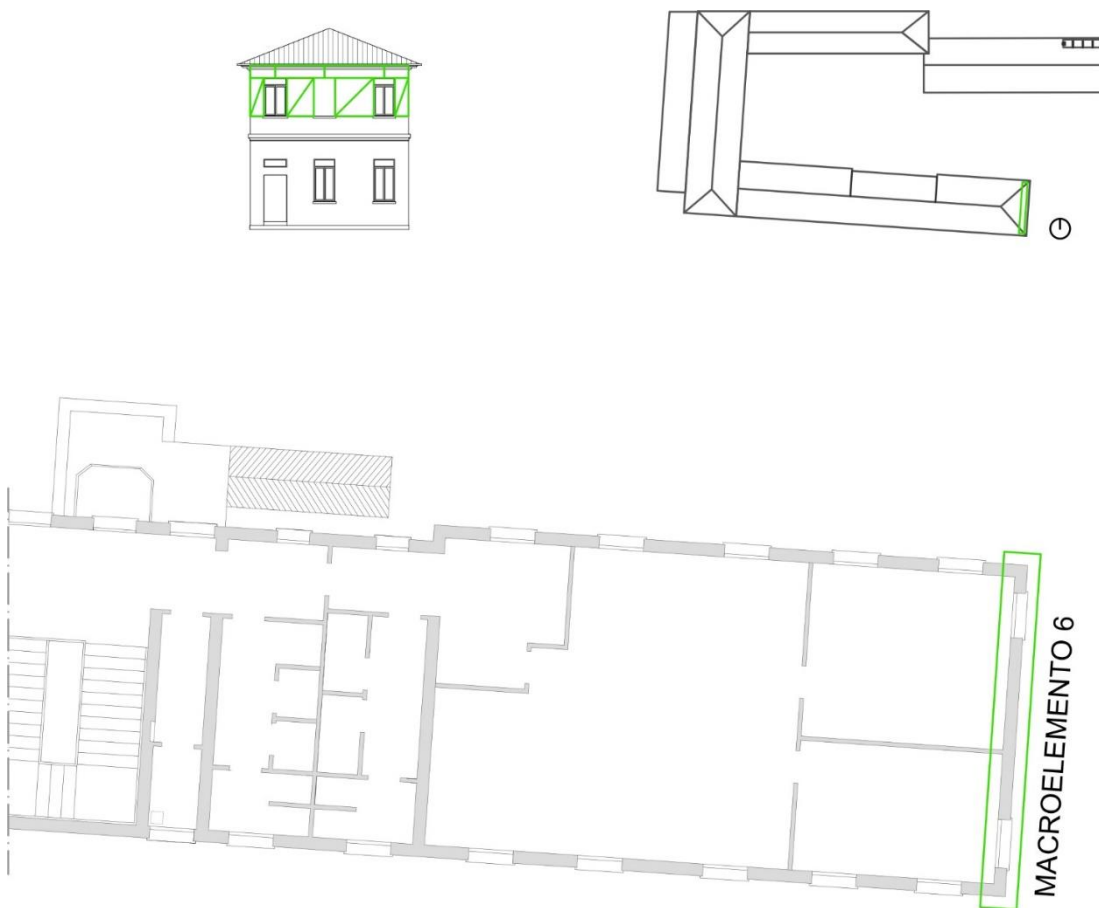
Figura 6.49 Individuazione del macroelemento in prospetto e pianta
