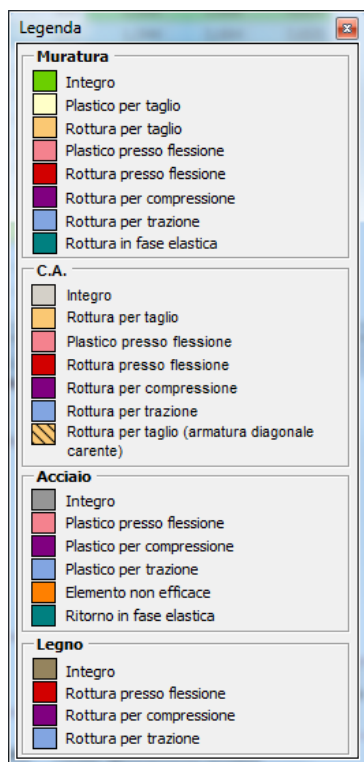
Figura 7.36 Legenda delle tipologie di rottura dei materiali utilizzati nel modello
