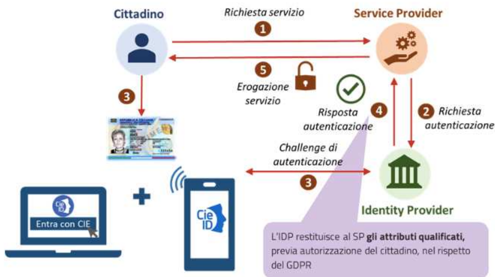
Figura 17: si evidenzia il percorso per entrare con identità digitale CIE.
