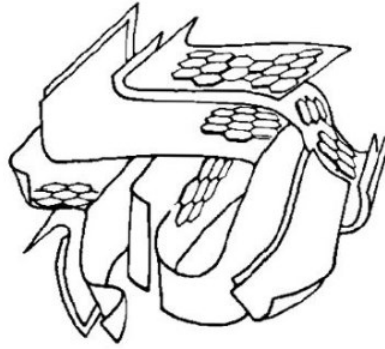
Fig. 2: Struttura interna del carbonio amorfo.
