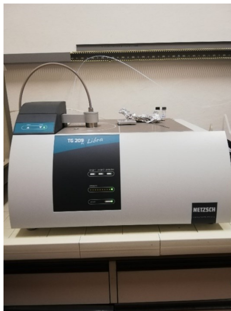
Fig 8: Strumento per misure termogravimetriche utilizzato in laboratorio.
