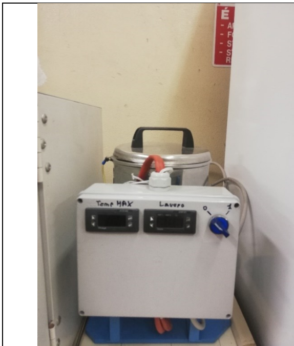
Fig. 5a: Pirolizzatore utilizzato in laboratorio.
