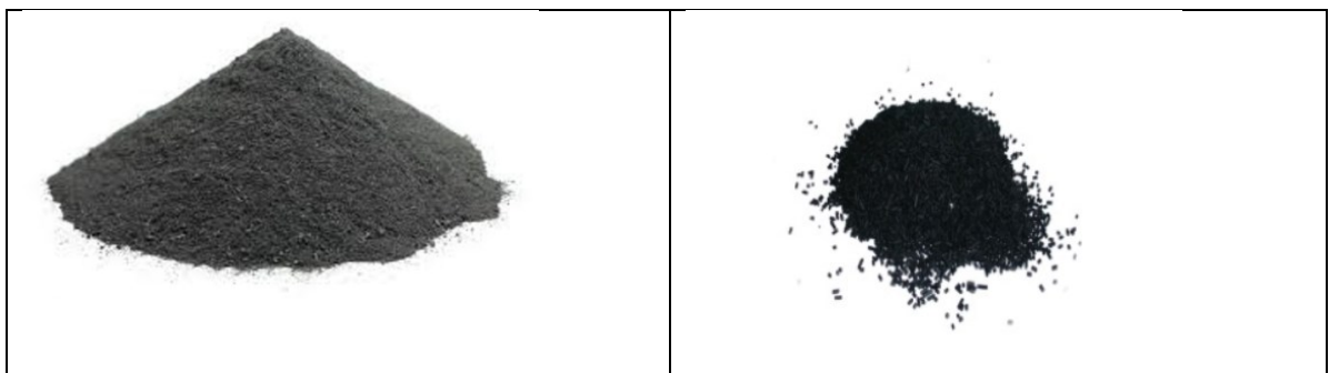
Fig. 3: le due forme del carbone attivo.
