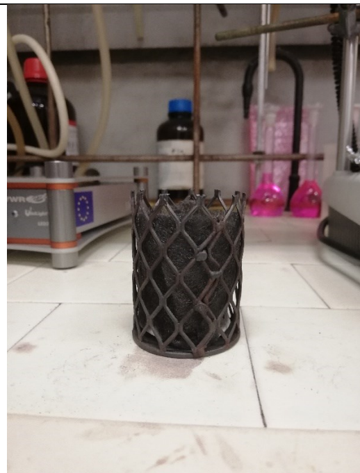
Fig. 5b: Contenitore interno del pirolizzatore.
