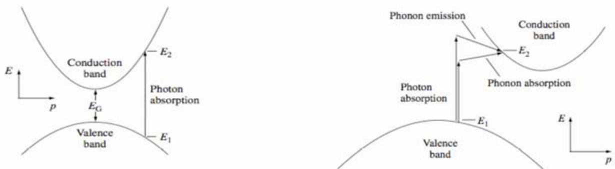
Figura 2.10: differenze nel diagramma a bande tra un semiconduttore a gap diretto ed uno a gap indiretto
