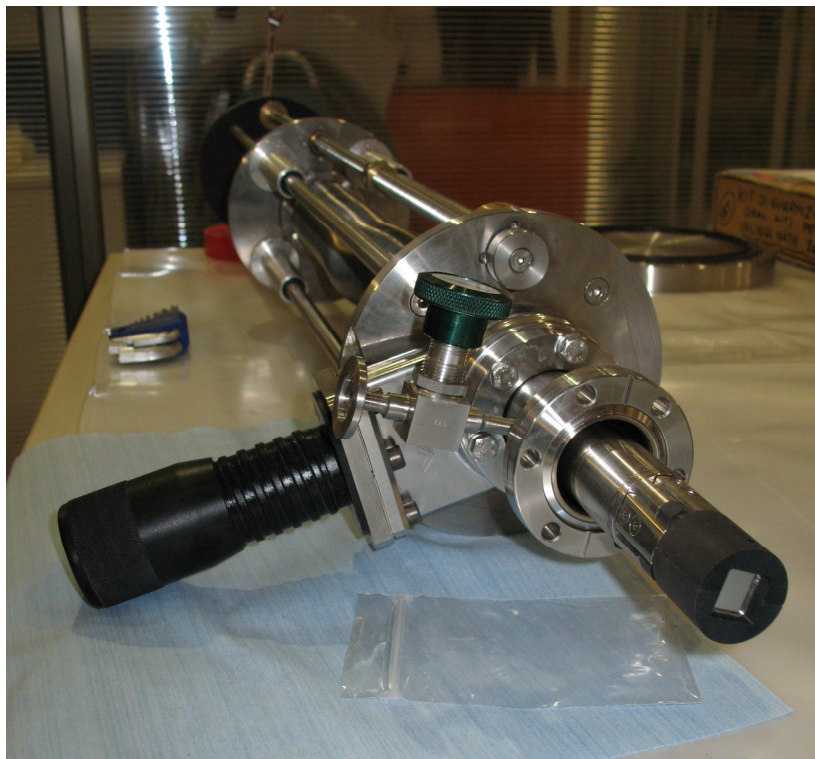
Fig. 6.1 Manipolatore porta provini con punta in grafite predisposta a sostenere la lamina in berillio come provino
