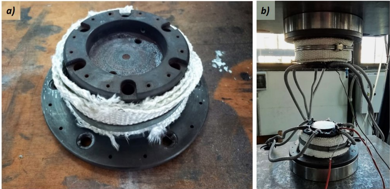
Figura 4.4. Equipaggiamento per la conduzione delle prove di stampaggio a caldo, (a) gruppo stampo inferiore, (b) set-up di prova montato.
