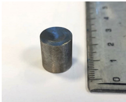
Figura 5.2. Provino utilizzato nelle prove di compressione in Gleeble 3800.
