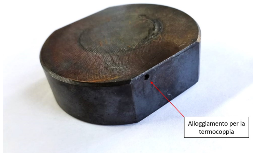
Figura 4.3. Inserto rappresentativo dello stampo da forgiatura a caldo in acciaio H13, rugosità 3.2 \mu\text{m} .
