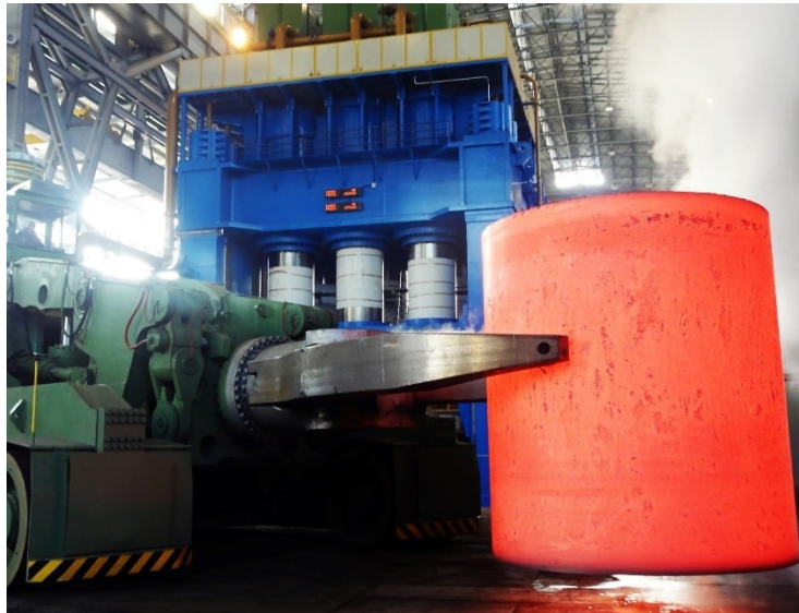
Figura I.1. Billetta impiegata nello stampaggio a caldo di componenti di grandi dimensioni mediante la pressa "Tyson" da 100'000 tonnellate presso l'azienda Forgiatura A. Vienna.
