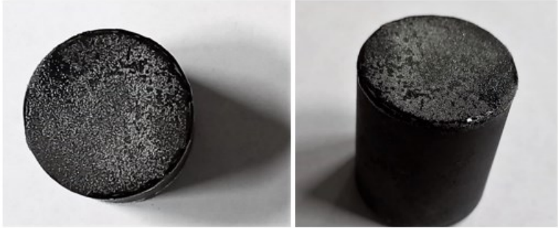
Figura 4.11. Applicazione del lubrificante solido PROVA 46/P sulle facce piane della billetta dopo preriscaldamento a 1120°C per 13 minuti e successiva pressione degli stampi sulla polvere.
