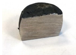
Figura 5.5. Campione di IN706 tagliato lungo l'asse di compressione. La superficie di taglio risulta molto scabra.
