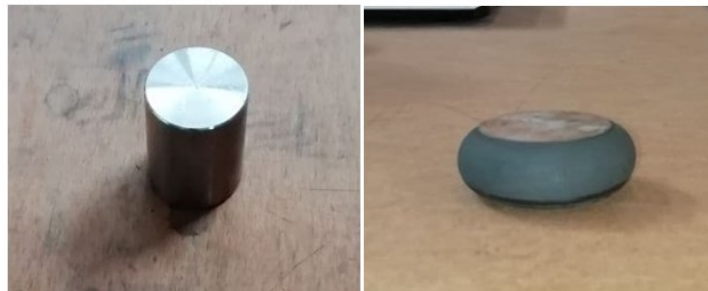
Figura 4.14. Billetta di prova prima e dopo la compressione. L'altezza viene ridotta da 35 mm a 17 mm.
