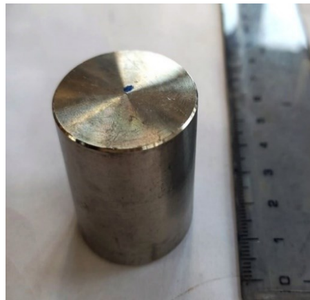
Figura 4.2. Billetta di IN706 utilizzata per le prove di attrito in Instron Wolpert KPX 1500 - Static Hydraulic System.
