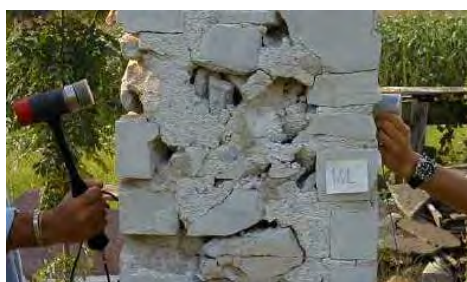
Fig. 2.16: Prova sonica diretta
