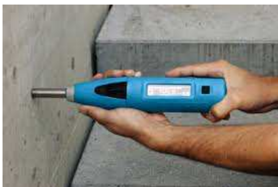
Fig. 2.9 : Prova mediante sclerometro
