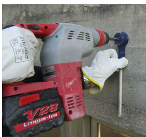
Fig. 2.11: Prova di penetrazione
