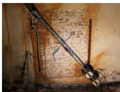
Fig. 2.5 e Fig.2.6 : Prova meccanica di compressione monoassiale (sinistra) e prova meccanica di compressione diagonale (destra)
