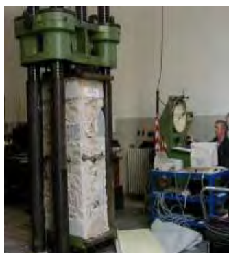
Fig. 2.5 e Fig.2.6 : Prova meccanica di compressione monoassiale (sinistra) e prova meccanica di compressione diagonale (destra)
